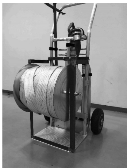
【写真 9】 ホースリールにホースを 巻き取りセットしたもの
