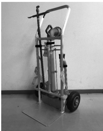
【写真5】既存のスタンドパイプ式 初期消火セットの台車
