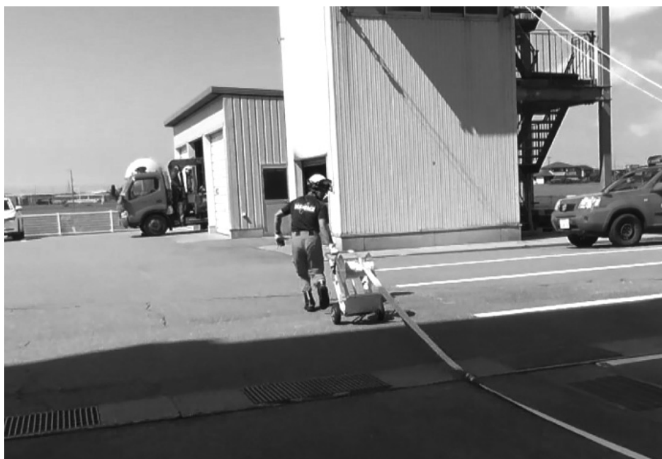
【写真 1 3】ホースリールが回転しホース展張
