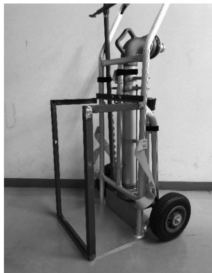
【写真6】台車にフレームを取り付け
