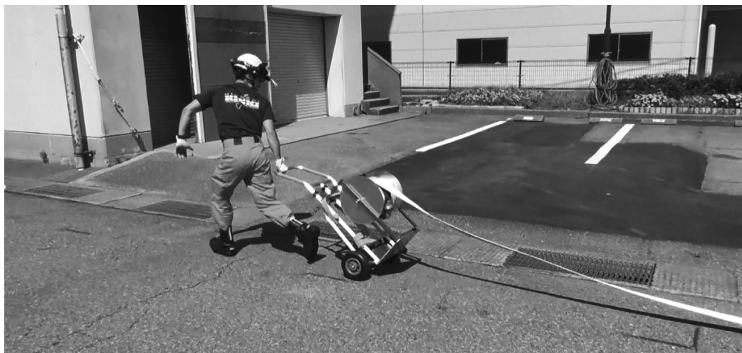
【写真 1 2】ホースリールが回転しホース展張
