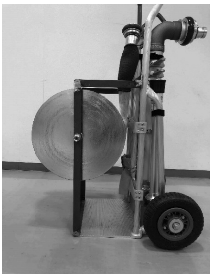
【写真 8】 フレームにホースリール をセットしたもの
